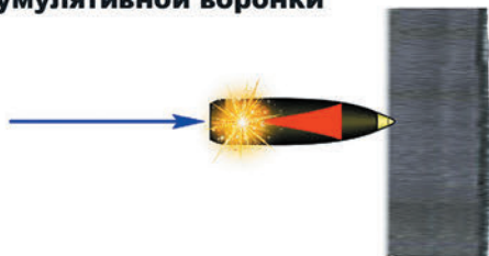
Фаза 1. Подрыв БЧ и начало схлопывания кумулятивной воронки
